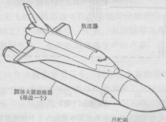
图 3 两级式第一代航天飞机的外貌和轨道级、助推级位置
