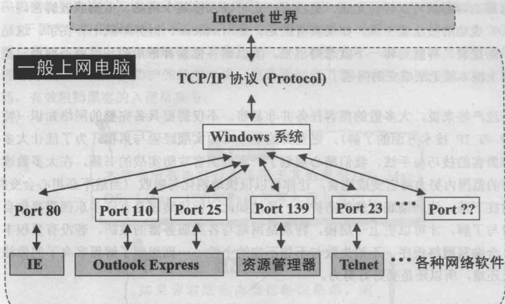
从上面的图中你可以清楚地看出在你电脑中的各种网络软件都是经由某一个端口再通过 Windows 系统的 TCP/IP 模块连接到 Internet 世界中，而同样的远程的服务器、网站主机或一般电脑也是以相同的方式来接收你电脑的信息 (或发送信息给你的电脑)，以此方式达成网络连接。
