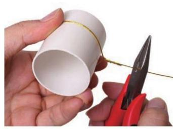
4. 剪：剪断多余铁丝，留出柄长1.5cm左右。
