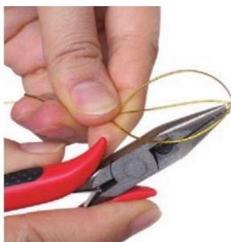
4.将铁丝的一头用尖嘴钳压紧，以防勾破丝网。
