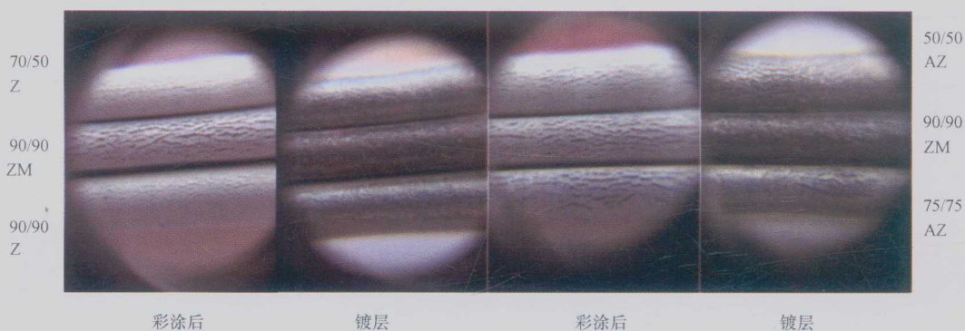
图 1-15 BZM 镀层 180 度折弯裂纹比较
