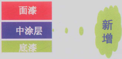
图 1-24 三涂层珠光氟碳彩涂钢板上表面涂层结构
