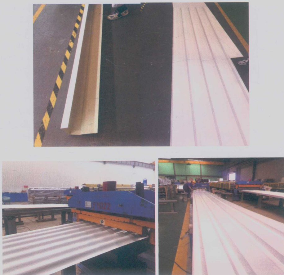
图 1-16 BZM 基板彩涂钢板压型试验
