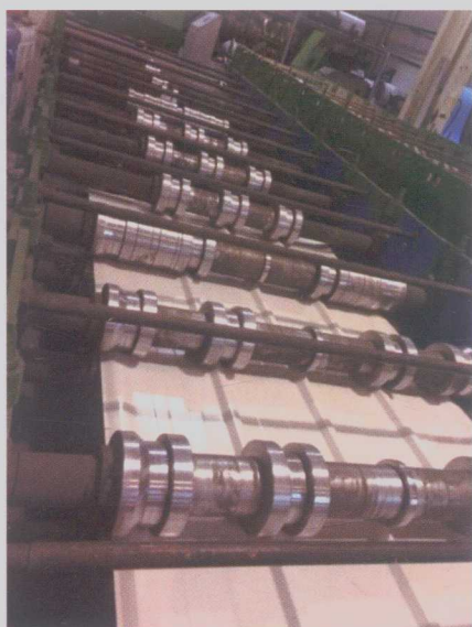
图 1-18 BAM 基板彩涂钢板压型试验
