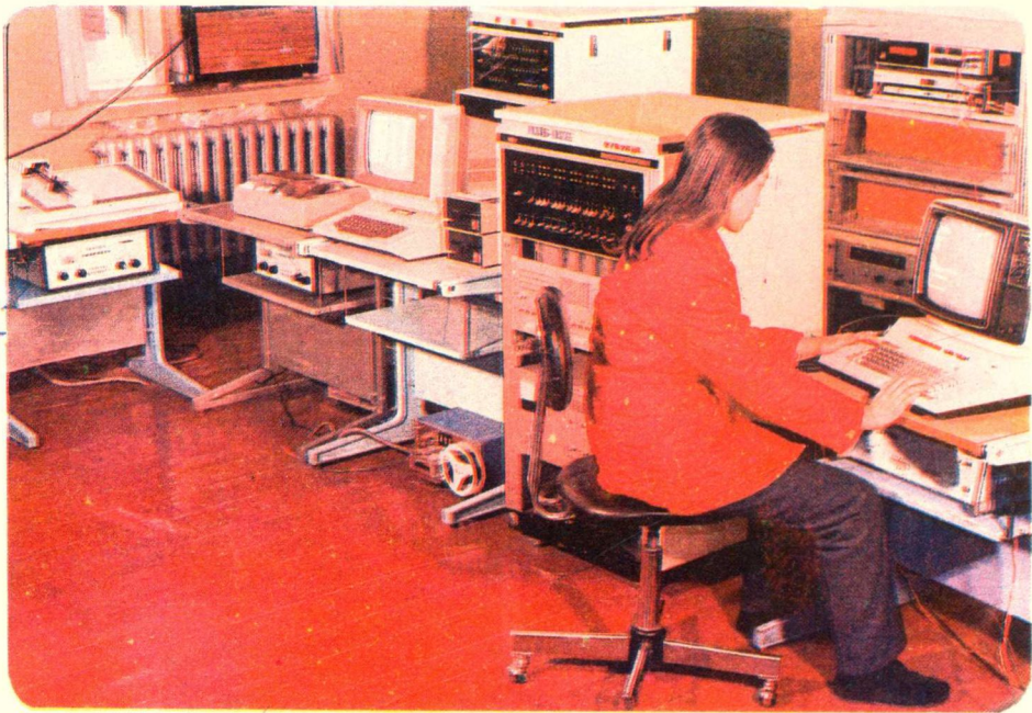
图1-7 FL-8 风洞测控系统
