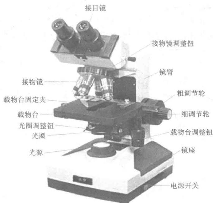
图 1.1.1 光学显微镜的构造
