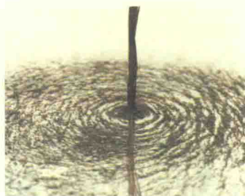
图1-21 直线电流的磁场
