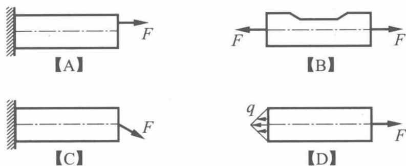
(3) 轴向拉压杆横截面上的正应力公式  $\sigma = F_N/A$  的主要应用条件是\_\_\_\_\_。
