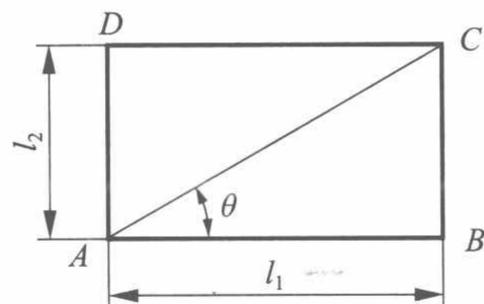
※ [1-3-3] 图示四边形平板变形后成为平行四边形 (虚线), 四边形  $AD$  边保持不变。试求: (1) 沿  $AB$  边的平均线应变; (2) 平板  $A$  点的切应变。
