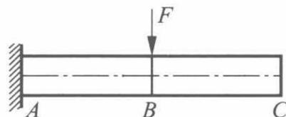
[1-1-2] 指出图示结构中  $AB$  和  $BC$  两杆的变形属于何类基本变形？
