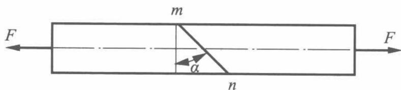
※ [2-3-3] 图示拉杆沿斜截面  $m-n$  由两部分胶合而成。设在胶合面上许用拉应力  $[\sigma] = 100\text{MPa}$  [或: ], 许用切应力  $[\tau] = 50\text{MPa}$ , 并设杆件的强度由胶合面控制。试问为使杆件承受的最大拉力为  $F$ ,  $\alpha$  角的值应为多少? 若杆件横截面面积为  $4\text{cm}^2$ , 并规定  $\alpha \leq 60^\circ$ , 试确定许可载荷  $F$ 。
