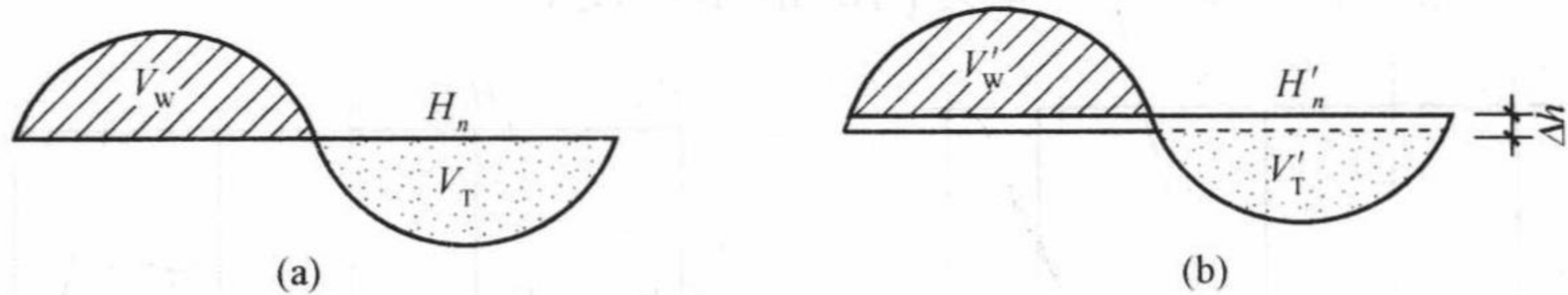
图 1-4 设计标高调整计算示意图
