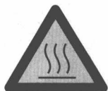
热表面警告标志 Hot Surface Warning Sign
