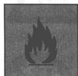
易燃标志 Flammable
