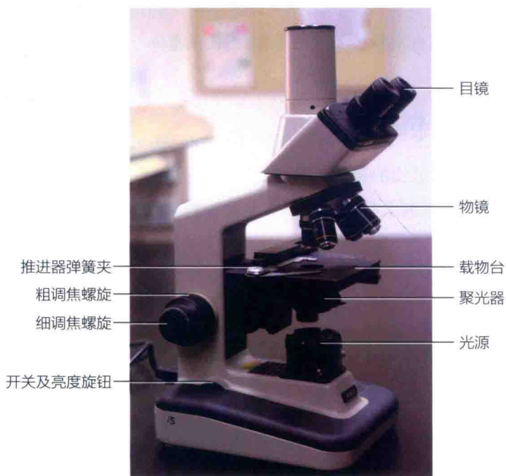
图0-4 显微镜的基本结构
