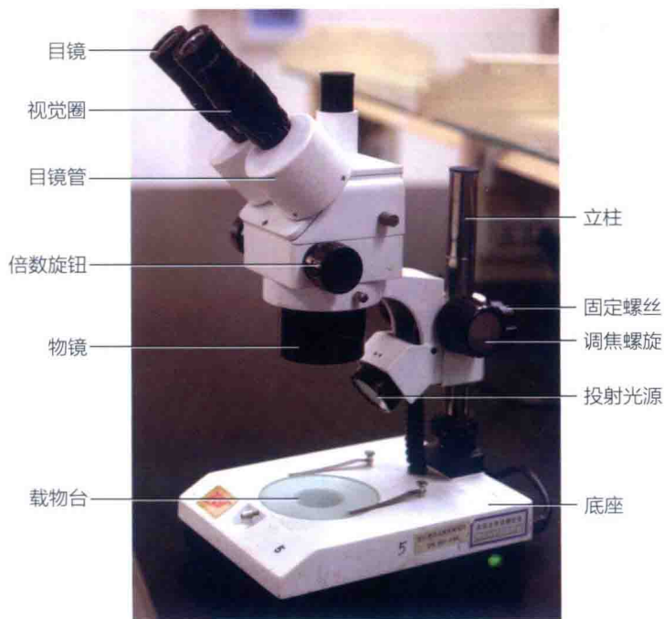
图0-3 解剖镜的基本结构
