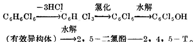
利用六六六无效异构体所进行的研究工作，是为了达到上述两种目的。目前，在試驗車間进行的五氯酚（包括六氯苯）的制造已告結束，已开始建立 2, 4, 5 - 三氯苯氧基醋酸中間試驗車間。
