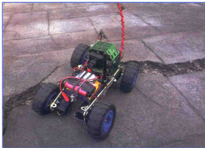
图 1.4 这辆携带摄像机的漫游车配备用于恶劣地形的凸块高花纹轮胎（图片来源：Geoffrey Irons 提供）
