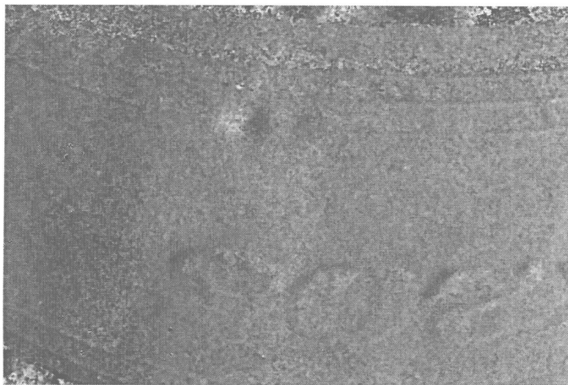
图 A.5 气泡或脱层的凸斑
