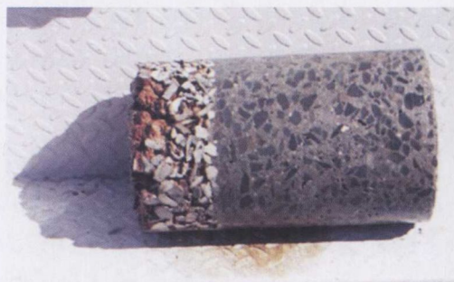
图 1-7 混凝土路面与排水层芯样
