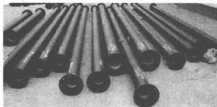
图 1.4 法兰式球墨铸铁管
