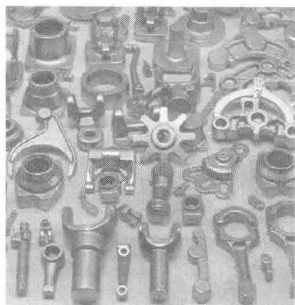
图 1.8 精密热模锻的各类锻件
