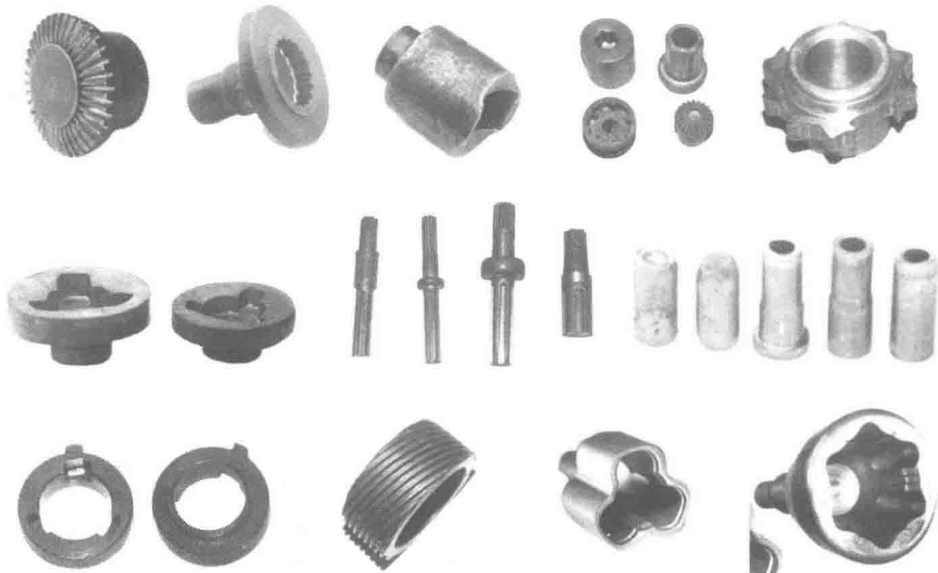
图 1.5 冷锻和温锻成形的各种精密锻件
