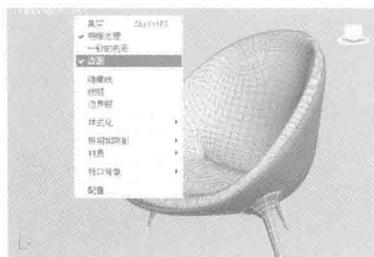
**5** “线框”显示方式。模型以它本身的网格线框形式显示，这个时候模型的材料是没有意义的。
