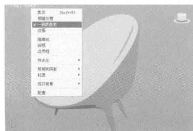
**4** “边面”显示方式。在物体显示的基础上以线框构造形式显示，但必须与“真实”、“明暗处理”和“一致的彩色”一起使用。
