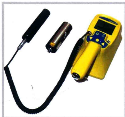
图2.4 CoMo170便携式表面沾污检测仪
