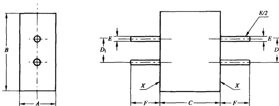
目的: 检验 G5.3 灯座(参见 19148.2—GB-73)与具有最大插脚长度、最大插脚直径及最小和最大插脚间距的灯头的匹配性能, 并检验最小支撑面(A×B)和凹孔的最大深度(C)。
