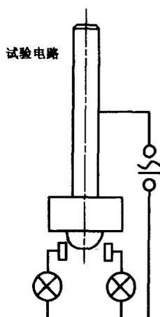
目的: 检验 G5 灯座的防触电性能。
