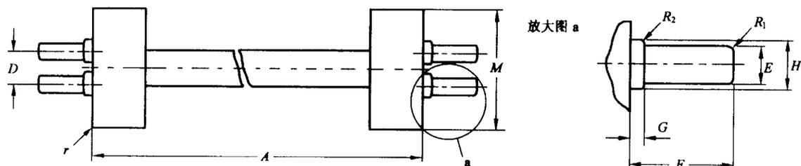
结构:以顺时针方向转动量规 I 和以逆时针方向转动量规 II,均能使其一端两插脚轴线所在的平面与另一端两插脚轴线所在的平面成一角度,在这种情况下,不用过度的压力也能将量规恰好插入两个槽宽均为 2.87 mm 的平行槽中(见 GB 10682 相应条款)
