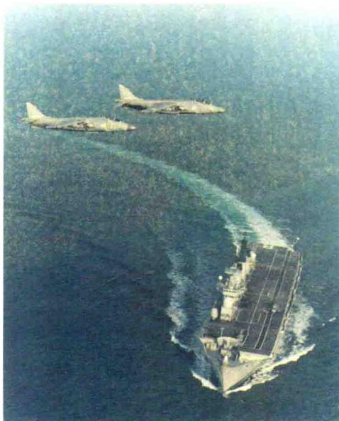
到，起飞跳板的坡度越陡，短距/垂直起降飞机所能携带的有效载荷就越大，飞行半径就越大。
