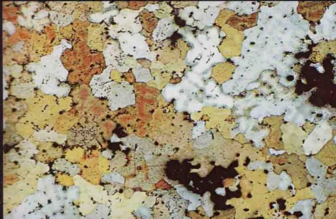
彩版2 中国铸铁狮子锈蚀残片。氧化铁外壳保存了原始金属结构的某些细节。抛光截面显示有斯氏体和残存的渗碳体。×200
