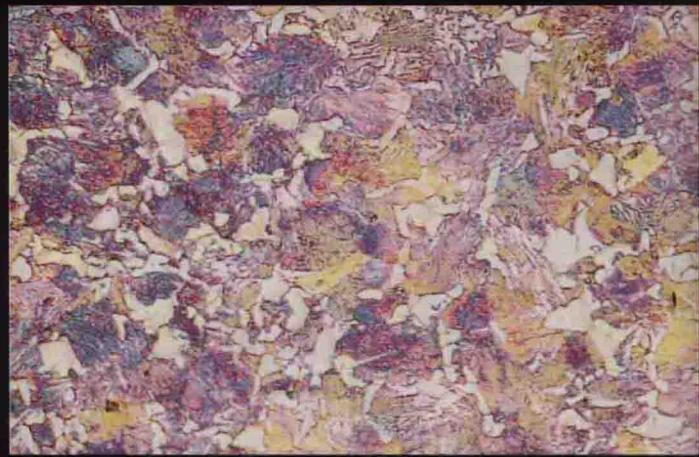
彩版17 巴勒斯坦青铜时代晚期青铜剑。含锡8.2%。三氯化铁盐酸酒精溶液浸蚀。显示加工和退火的晶粒结构。可见一些孪晶，晶粒大小不一，另有一些孔洞，呈深色，系腐蚀所致。也见一些晶间裂痕，反映可能存在过度加工。 $\times 120$
