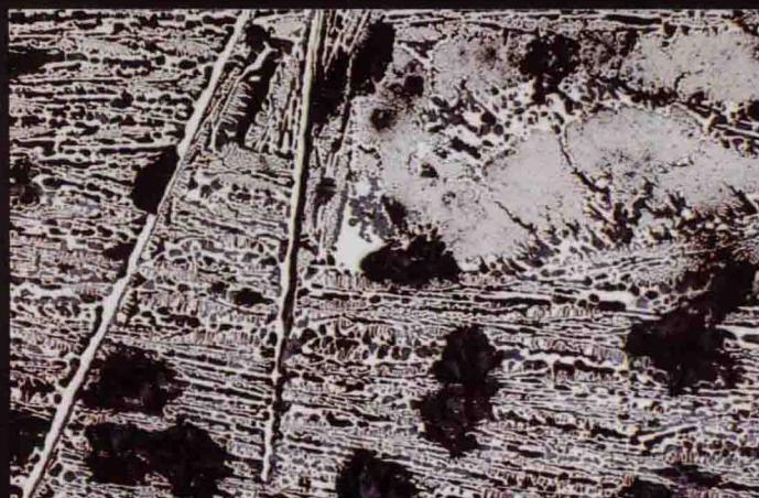
彩版13 Sandal城堡铸铁炮弹高放大倍数显微照片。可见大的石墨片和珠光体，珠光体中的铁素体和渗碳体组分可分辨。硫代硫酸盐/醋酸盐彩色效应浸蚀剂浸蚀。 $\times 500$ （见图118~图120）
