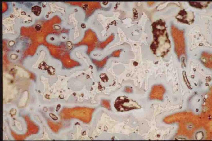
彩版20 公元前125年希腊人物雕像基底内部试样截面。铅青铜铸造，含铅18.5%、锡11.5%和铜68.5%。其结构表明该人物雕像系铸造而成。用硒沉积着色的方法浸蚀，清楚地显示出铸造青铜的晶内偏析。富铜部位呈橘色而富锡部位呈蓝灰色。因为含锡量高，白色 $\alpha + \beta$ 共析体呈网状分布于金属基体。 $\times 220$
