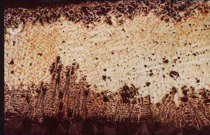
彩版4 拉·彼鲁兹（La Perouse）号沉船黄铜勋章残片。该船于1726年沉没于澳大利亚海岸。样品用三氯化铁盐酸酒精溶液轻度浸蚀，显示出明显的铸造黄铜树枝晶结构。铜和锌都因腐蚀而流失，腐蚀深入金属内部。腐蚀导致黄铜中锌流失很常见，但此件样品出现了树枝晶区域的铜流失现象，铜腐蚀产物占据了树枝晶间的空间。×70
