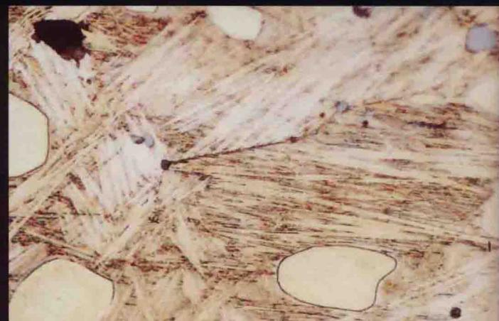
彩版9 约公元前120年的希腊人物雕像(Greek Herm)截面。用铜68.5%、锡11.5%和铅18.5%的合金铸造。硫代硫酸盐/醋酸盐彩色效应浸蚀剂浸蚀。 $\alpha + \delta$  共析体部位染成浅紫色，而 $\alpha$  相为蓝到紫色，铅球粒未受影响。颜色的变化，特别是 $\alpha + \delta$  共析体周围颜色变化显示了合金中的偏析。 $\times 240$
