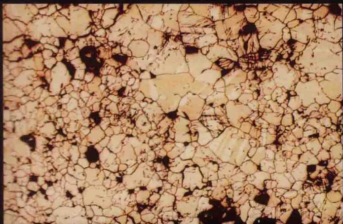
彩版18 印度中世纪晚期锌币抛光和浸蚀截面。使用Palmerton浸蚀剂，反射偏振光照相。放大60倍能清楚地看到锌孪晶，据此可以认为锌币坯是铸造的，再冲压成钱币。
