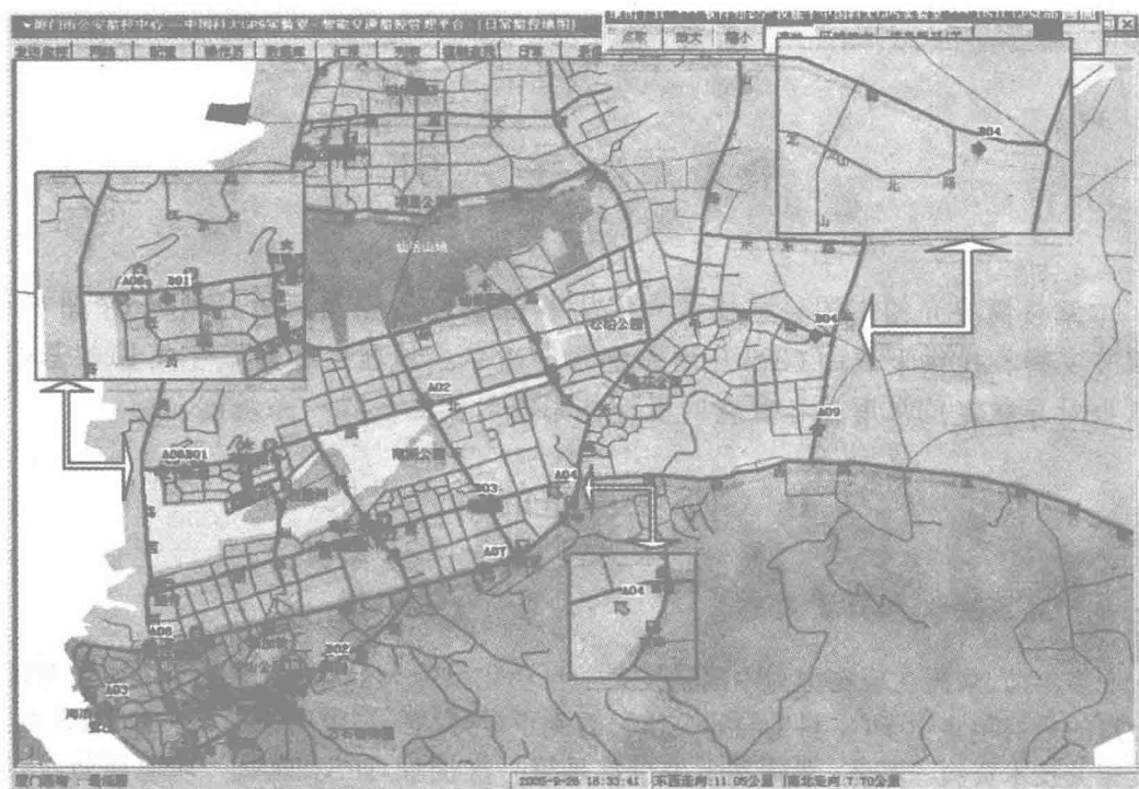
图 1-1 没有动态偏差校正功能的厦门市特种车辆智能安全监控系统
