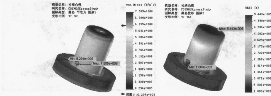
图 1-3 用 SolidWorks 内置工具 COSMOSXpress 对拉深凸模所做的应力及变形分析
