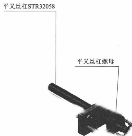
图 1-14 平叉丝杠与平叉丝杠螺母连接图
