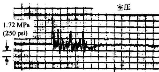
图 6 显示 F-1 发动机 FRT 喷注器衰减特性的压力曲线
