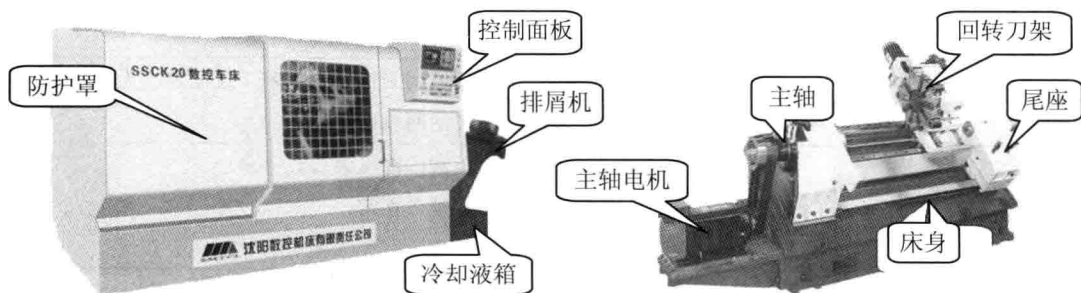
图 1-0-6 斜床身—斜滑板数控车床 (回转刀架)
