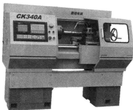
图 1-0-5 平床身—平滑板数控车床 (电动四方刀架)
