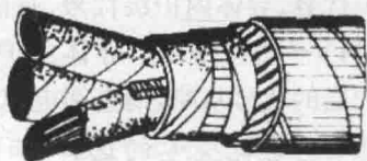
图 1.2 油浸纸绝缘钢带铠装电缆结构
