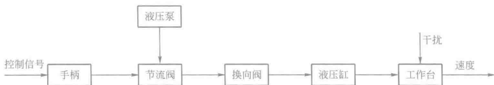
图 1.3 磨床工作台液压传动开环控制系统工作原理框图
