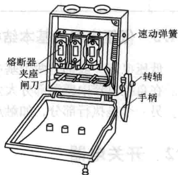
图 1-2 HH 系列封闭式负荷开关的结构与外形
