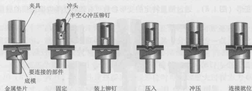
图 1.5 使用半空心铆钉进行冲压铆接的压入过程
