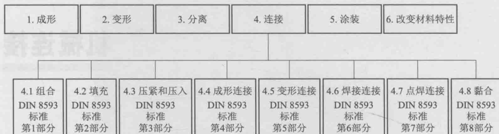
图 1.2 按照 DIN 8593 标准的 8 个标准化分类划分生产工艺“连接”的第四个主类别
