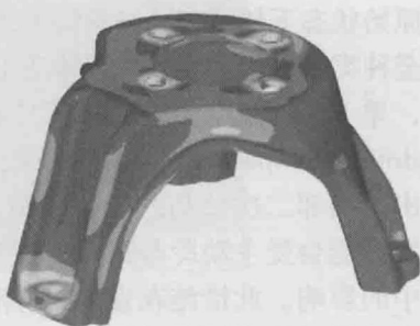
图 1.2 详细设计方案的应力模拟
