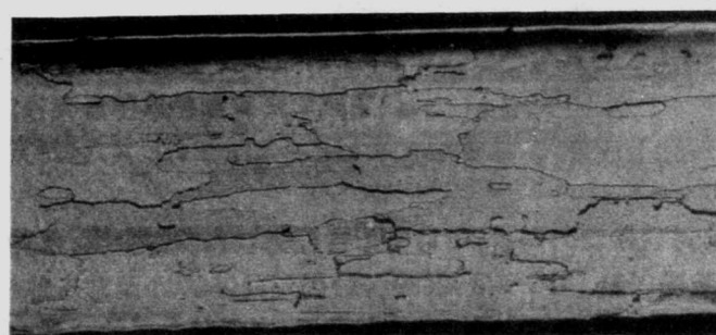
图 2 WAL2 \phi 0.4 mm 钨丝金相组织(放大 100 倍)
