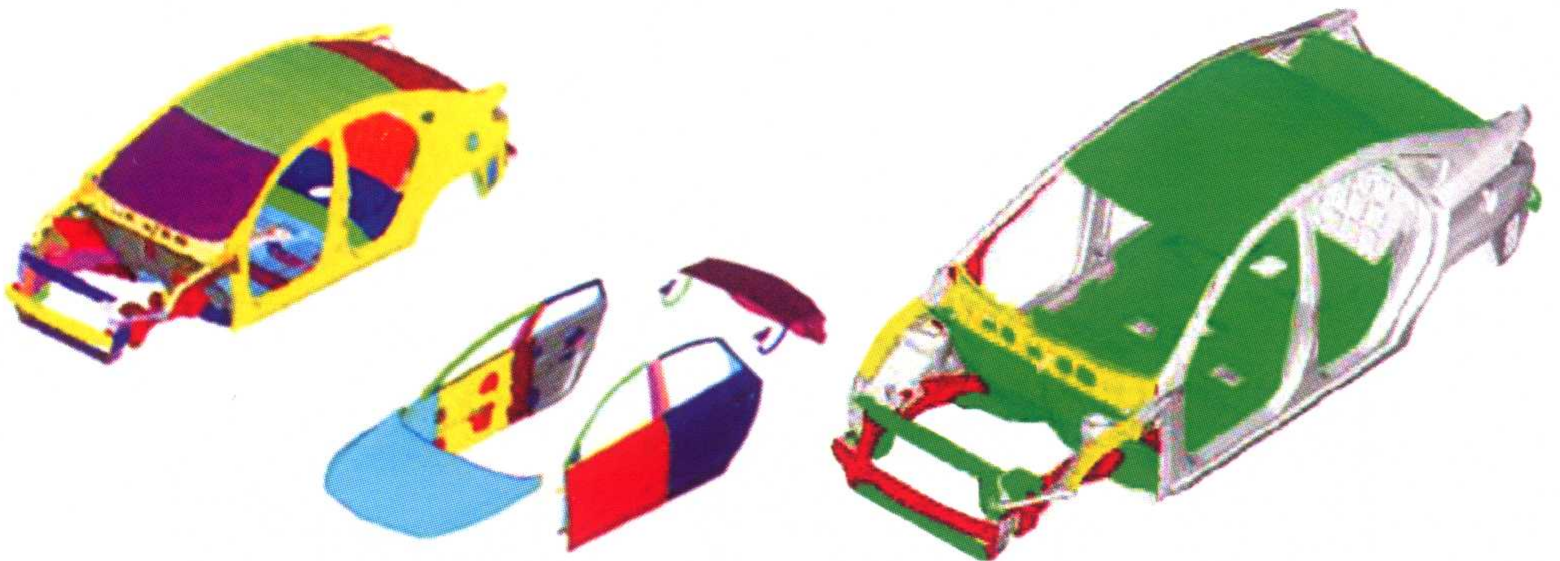
图 3.57 整车碰撞有限元模型
