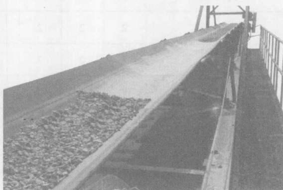
图 T0301-1 在皮带运输机上取样方法
