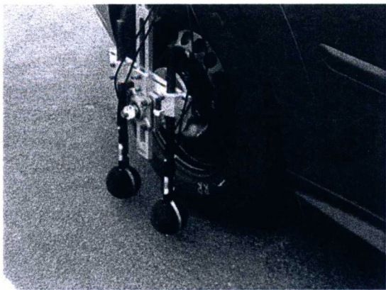
图 C.2 具有两个探头的典型装置(分别安装在前沿和后沿位置)
