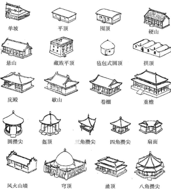
图1-8 各种屋顶示意图
