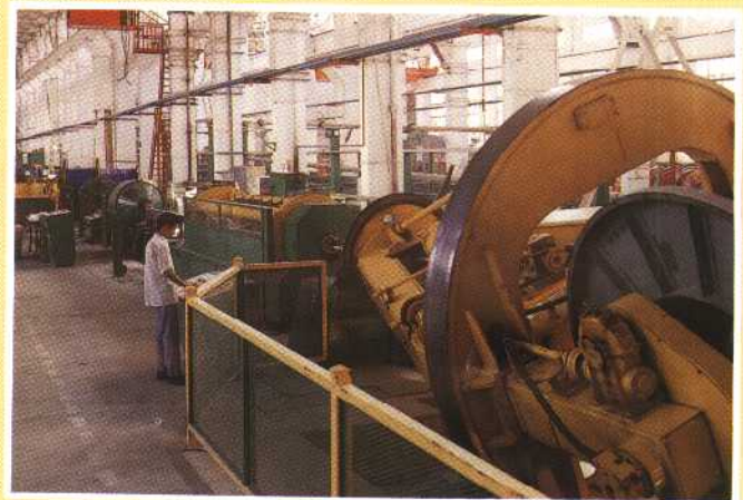
從美國引進的 \phi 3000 盤式成纜機
