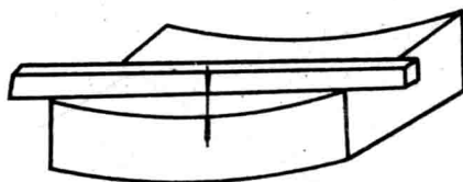
图 6—1 大面弯曲量法示意图
