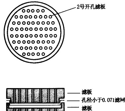
图2 滤板结构图
