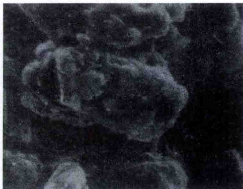
4. 长条形集粒, 晚更新世黄土 (兰州崔家崖)
