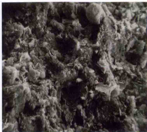
8. 凝块胶结结构, 晚更新世黄土 (陕西洛川)
