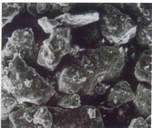
6. 骨架颗粒支架排列, 晚更新世黄土 (陕西靖边)
