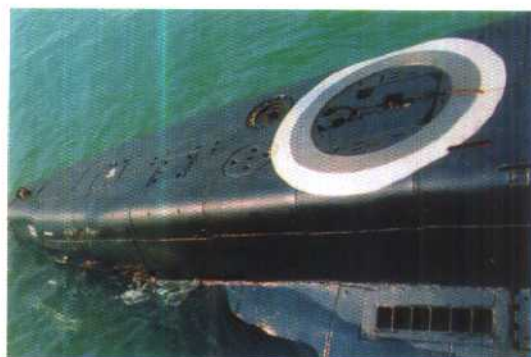
上层后端特写。白色圆内是兼用作离艇口的升降用舱口。画面左手为艇尾方向。
