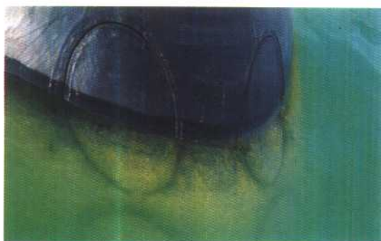
艇首鱼雷发射管口特写。该艇鱼雷发射管为二层叠放式，上层2门，下层4门，半露出水面的是上层发射管口。
