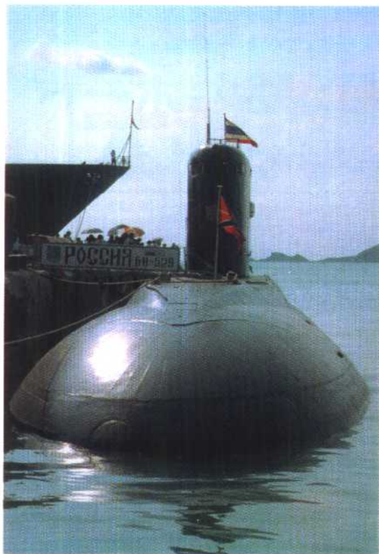
艇首鱼雷发射管口特写。该艇鱼雷发射管为二层叠放式，上层2门，下层4门，半露出水面的是上层发射管口。
