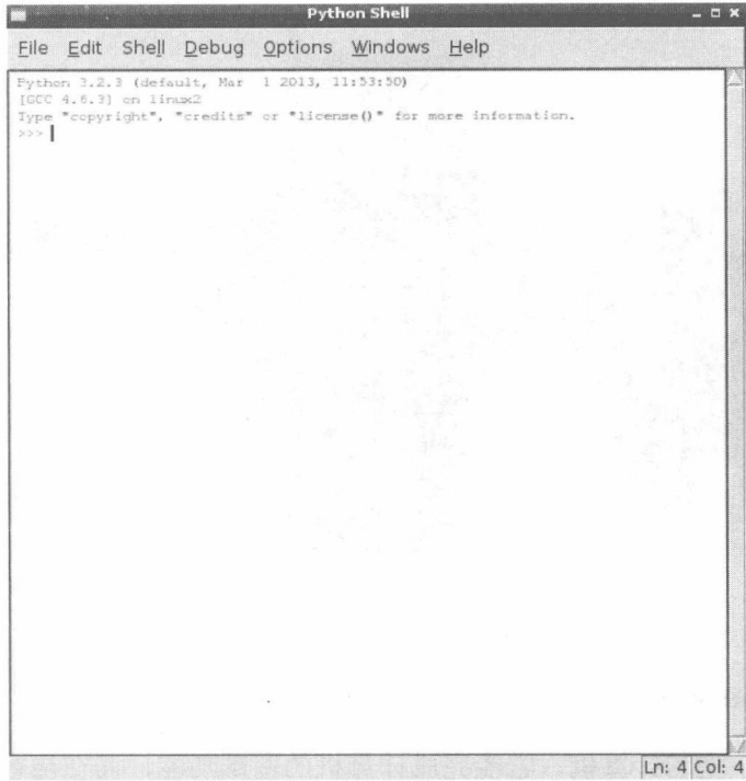
图 1.12 在树莓派上使用 IDLE3 进行脚本语言 Python 的开发
