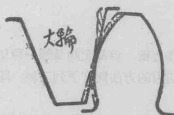
半滚动伞齿轮的齿形： 实线表示实际齿形； 虚线表示理论齿形。
