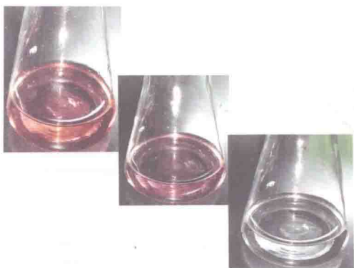
图 1 滴定法测定植物组织的呼吸速率示意图
