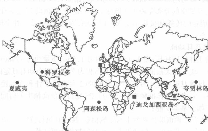
图 1.5 GPS 的地面监控部分
