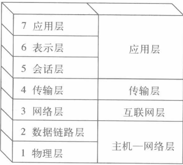
图1-13 OSI模型与因特网模型的对比
