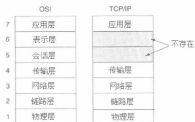
图 1.2 TCP/IP 与 OSI 参考模型
