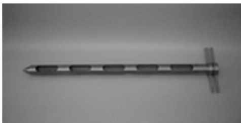
图 2.3 双套回转取样管示意图
