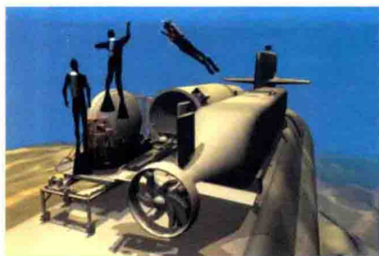
为特种作战、近海作战设计的可安装在大型潜艇上的微型潜水器
